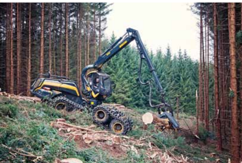
Kabinos išlyginimo funkcija operatoriaus darbo vietą išlaiko stabilia
