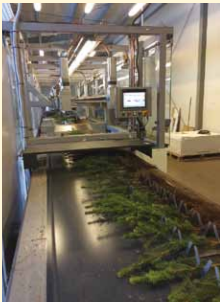
2 pav. Automatizuota „ECO Seedling Protection“ sodmenų vaškavimo linija
