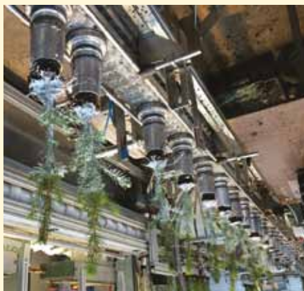
3 pav. Automatizuota „WeevilStop“ sodmenų vaškavimo linija
