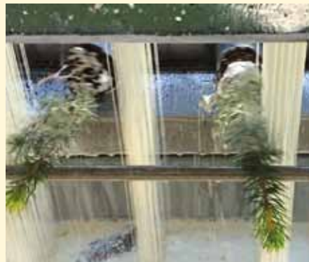
4 pav. Automatizuotos „WeevilStop“ sodmenų vaškavimo linijos procesas: a – sėjinukai padengiami vašku, b – atvėsunami šaltu vandeniu, c – sėjinukai nudžiovinami vėju
