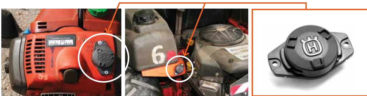
Sensorius galima sumontuoti krūmapjovėje, Rider traktoriuke ar kitame įrenginyje
