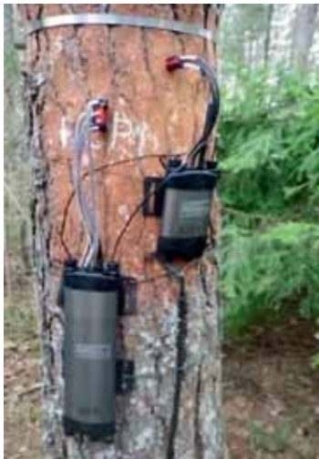
5 pav. Sulčių tėkmės balana matavimo įranga: rankinis juostinis dendrometras
